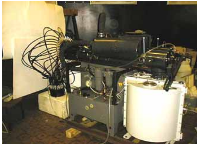
Формирователь короткоимпульсных сигналов при работе на эквивалент нагрузки
