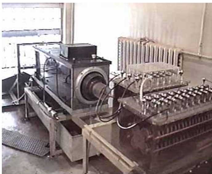
Рисунок 2 - Формирователь импульсов поля с начальным участком полеобразующей системы излучателя «Актив»
