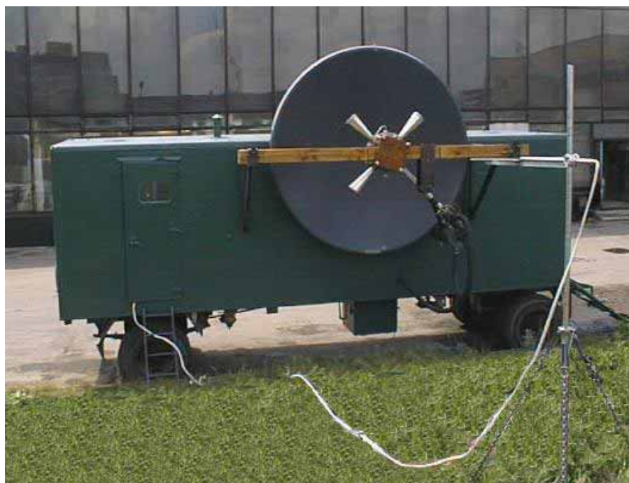
Рисунок 4 - Излучатель СК ЭМИ «Снайпер», на автомобильном прицепе ПАУ-1
