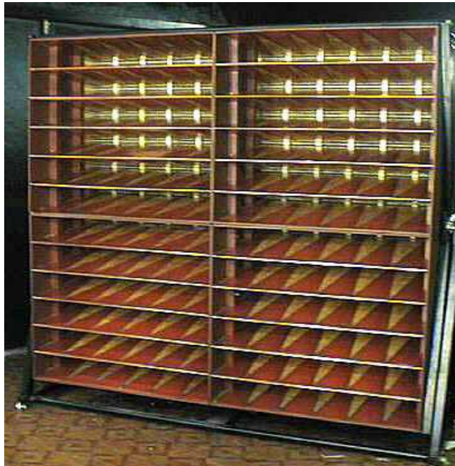
Антенная решетка 2м·2м из 144 ТЕМ рупоров Рисунок 5 - Излучатель СК ЭМИ «Снайпер-М»
