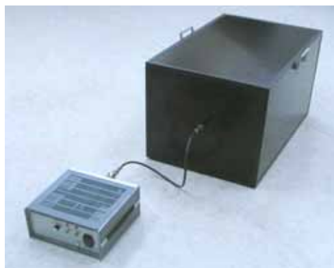
Рисунок 7 – Переносной излучатель СК ЭМИ «И – 40/6» с излучающей антенной на основе решетки из 6-ти ТЕМ рупоров
