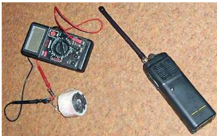
Рис. 2. Приборы, использовавшиеся при эксперименте. Слева антенна «таблетка», справа «Беркут-603»
