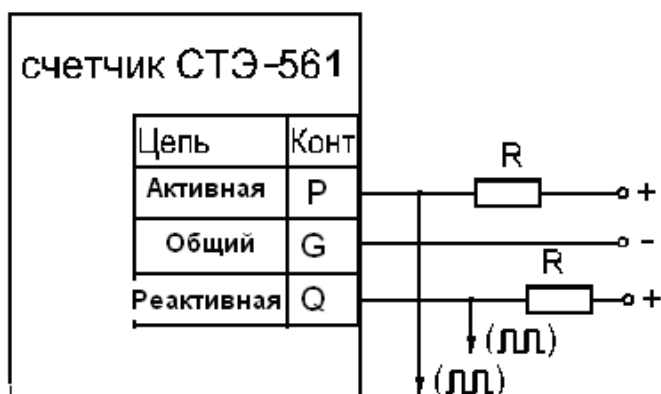
Рис. 1.2.11 Схема подключения импульсных выходов
